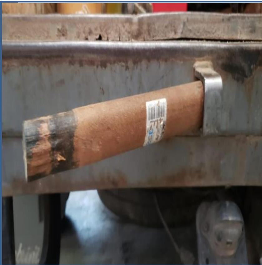
O meio oficial de pedreiro necessitou fazer um corte na ponta do cabo de marreta para fixação de cunha, pois a ferramenta estava com folga e sem firmeza.
